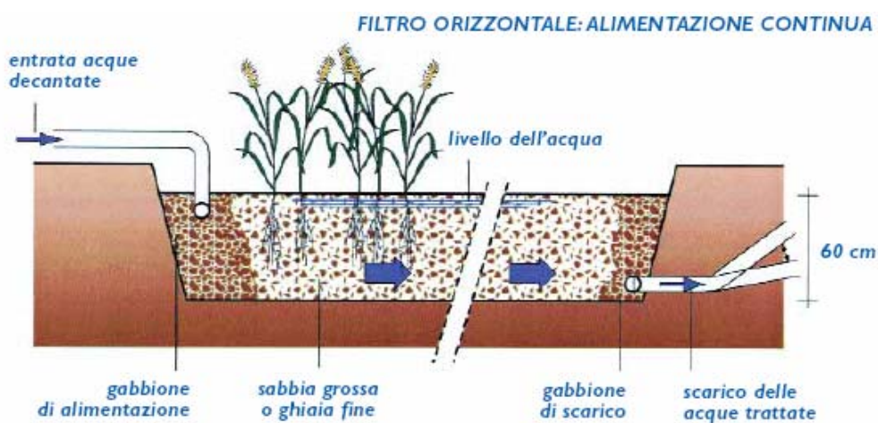
Figura 2: Schema di sistemi a flusso subsuperficiale orizzontale
